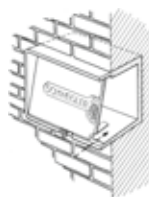
◀ Bild 1: In Fassade eingebaut
