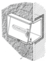
◀ Bild 2: In die Fassade eingebaut mit Isolierung von ca. 4 cm gegen Kältebrücken
